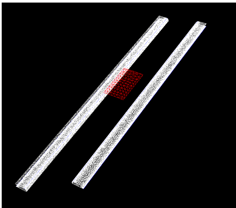
Figura 4.6 – Malha dos dutos, inlet e retorno
